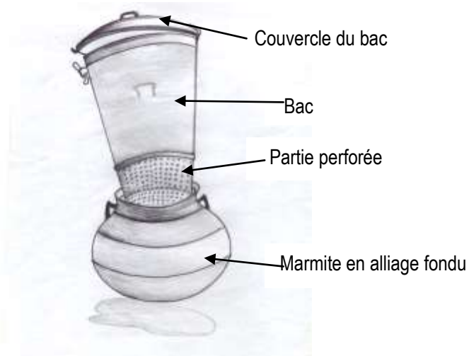
Figure 2. Les 2 composantes du dispositif amélioré d'étuvage du riz
