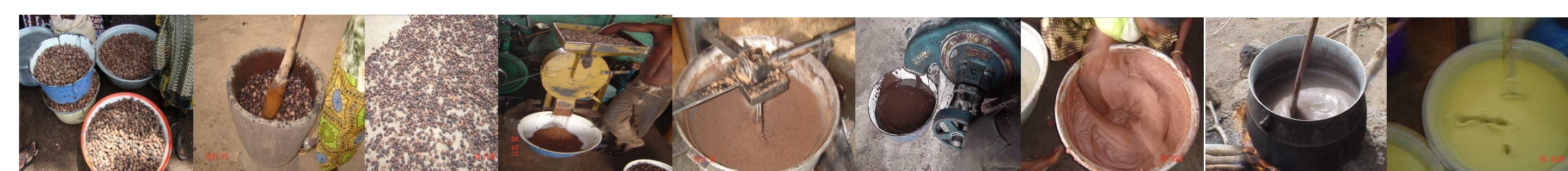
Amandes → Lavage → Séchage → Concassage → Torréfaction → Mouture → Barrattage → Cuisson → Beurre de karité
