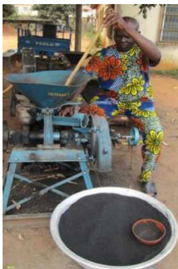
Figure 12 : Mouture du tourteau carbonisé
