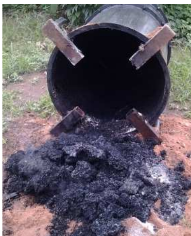
Figure 11 : Déchargement du carbonisateur et du tourteau de coques carbonisé
