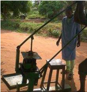
Figure 15: Manipulation de la presse manuelle de briquette.
