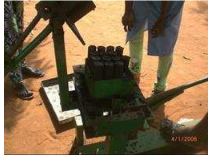
Figure 16: Ejection de briquette après pressage
