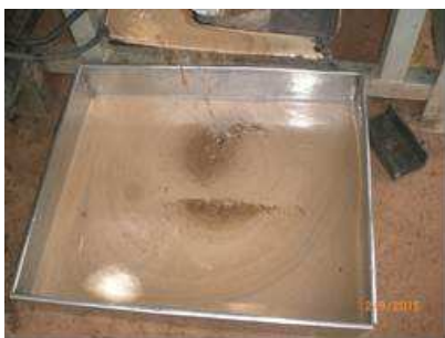
Figure 8: Baume de coque de noix de cajou extrait.
