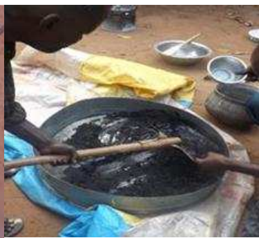
Figure 14 : Mélange de l'empois d'amidon avec la poudre de tourteau carbonisé de coque de noix d'anacarde.
