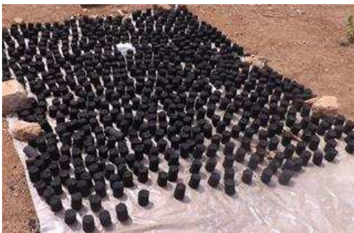
Figure 18 : Séchage au soleil de briquettes extrudées.
