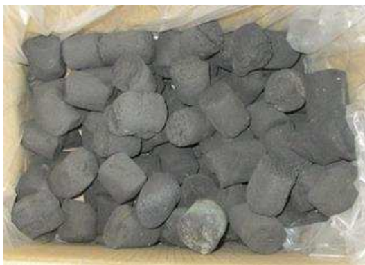
Figure 19 : Briquettes extrudées séchées au soleil.
