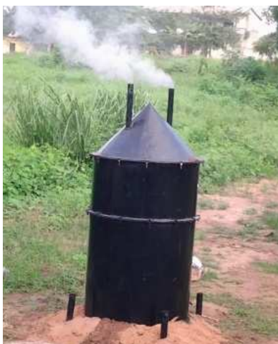
Figure 10 : Carbonisation du tourteau de coques déshuilées
