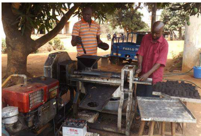
Figure 17 : Production de briquette à 'aide de l'extrudeuse
