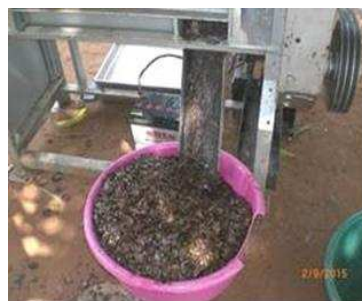
Figure 9: Tourteau de coque de noix de cajou.
