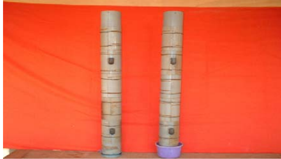
Figure 1 : Tube en PVC pour l'étude de l'architecture racinaire et de l'absorption hydrique sur tout le profil du sol
