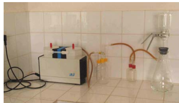
Figure 2 : Dispositif de filtration des oeufs après désinfection : entonnoir de filtration, fioles pièges à liquide et pompe à vide
