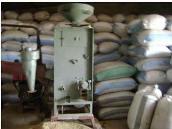
Figure 15 : Décortiqueuse à rouleaux
