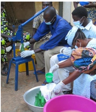
Figure 12: Embouteillage et encapsulation du jus de ahipa.
